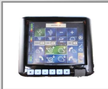
Les fonctions sont contrôlées à l'aide d'un écran tactile intuitif et d'un manipulateur installés à l'intérieur de la cabine du véhicule.
