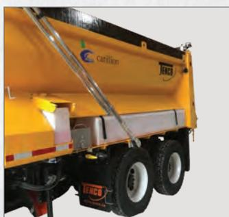
Réservoirs\* de liquide de pré-trempage en option intégrés dans le corps de la benne.
