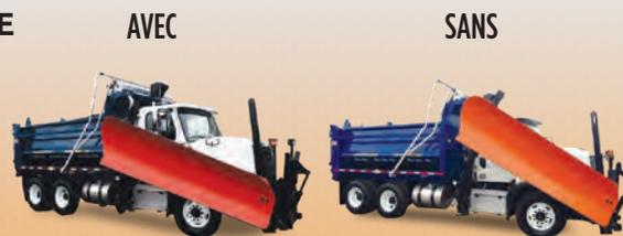
Les ailes sont offertes en acier ou en Tenelene, un matériau plus léger et résistant à la corrosion.
