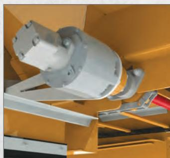
Convoyeur principal entraîné par un engrenage planétaire accouplé à un moteur de 10 po<sup>3</sup> et à un arbre d'entraînement de 2".
