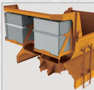
Réservoirs\* de liquide de pré-trempage en option sous le pare-cabine.
