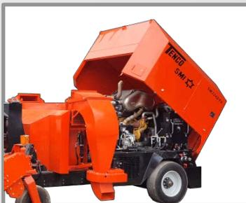
Le capot bascule par l'arrière permettant un accès complet au moteur.
