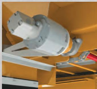
Convoyeur principal entraîné par un engrenage planétaire accouplé à un moteur de 10 po<sup>3</sup> et à un arbre d'entraînement de 2".
