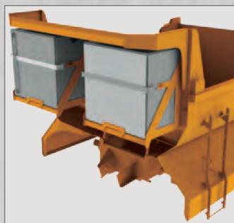
Réservoir\* de liquide de pré-trempe en option sous le pare-cabine.
